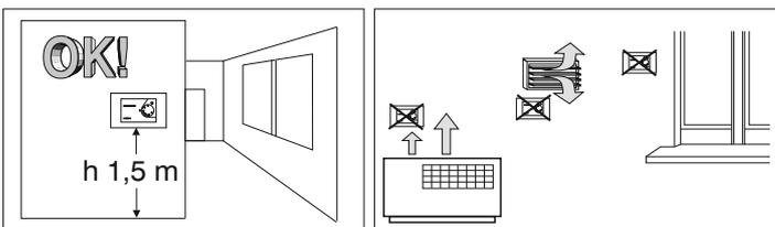
Installare preferibilmente il termostato a quota  $1,50 \div 1,70$  m dal pavimento; lontano da sorgenti di calore, prese d'aria, porte o finestre e da quanto possa influenzarne il funzionamento.
