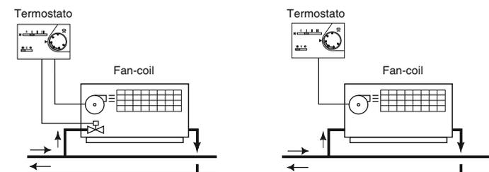
*Esempio d'installazione con termostato che comanda il ventilatore e l'elettrovalvola.*
