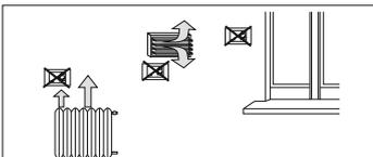
Installare preferibilmente il termostato a quota 1,50 ÷ 1,70 m dal pavimento; lontano da sorgenti di calore, prese d'aria, porte o finestre e da quanto possa influenzarne il funzionamento.
