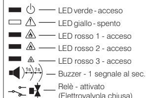
Fig. 7 - Stato di "allarme presenza gas" e attivazione del relè.
