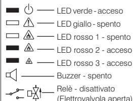
Fig. 5 - Stato di segnalazione bassa concentrazione di gas
