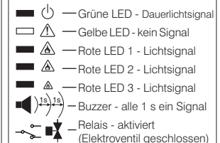
Abb. 7 - Zustand "Gasalarm" und Relaisaktivierung
