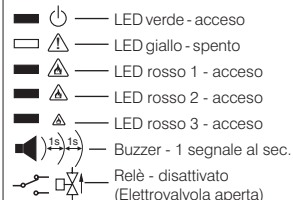
Fig. 6 - Stato di "allarme presenza gas"
