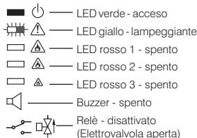
Fig. 2 - Stato operativo "funzionamento non operativo"
