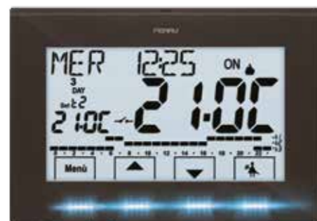
Tra i 18,1 °C e 21 °C i tasti si illuminano di blu indicando un consumo ottimale
